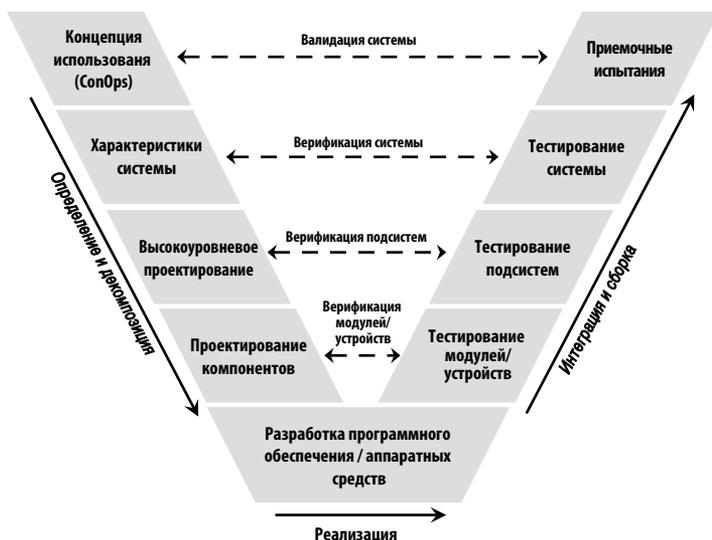
Рис. 2-2: V-модель процесса системной инженерии.
