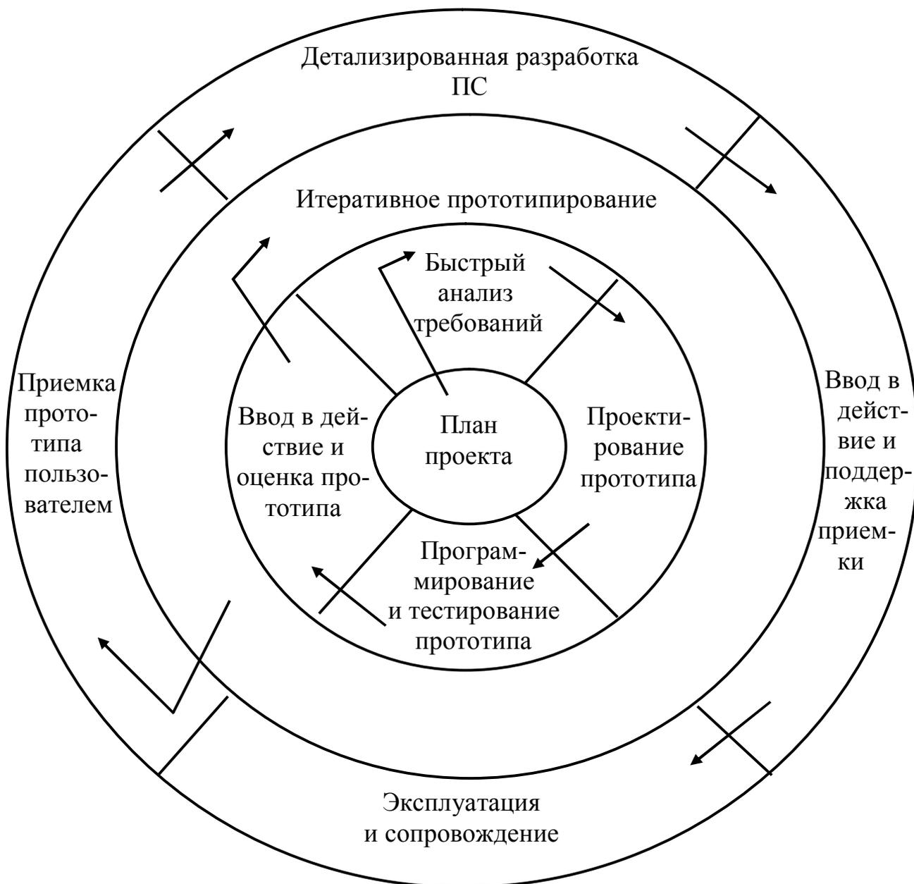
Рис. 2.16. Структурная эволюционная модель быстрого прототипирования
