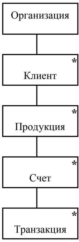
Рис. 4.39. Иерархический вид сетевой структуры данных
