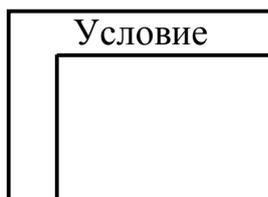
Рис. 4.18. Представление цикла с предусловием в схемах Насси–Шнейдермана
