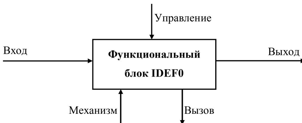
Рис. 5.1. Основная конструкция IDEF0-модели
