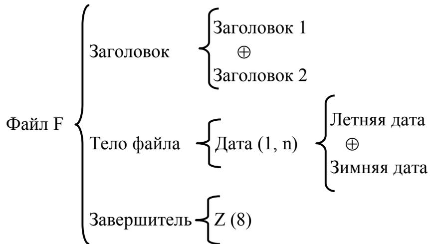
Рис. 5.55. Пример иерархической структуры данных
