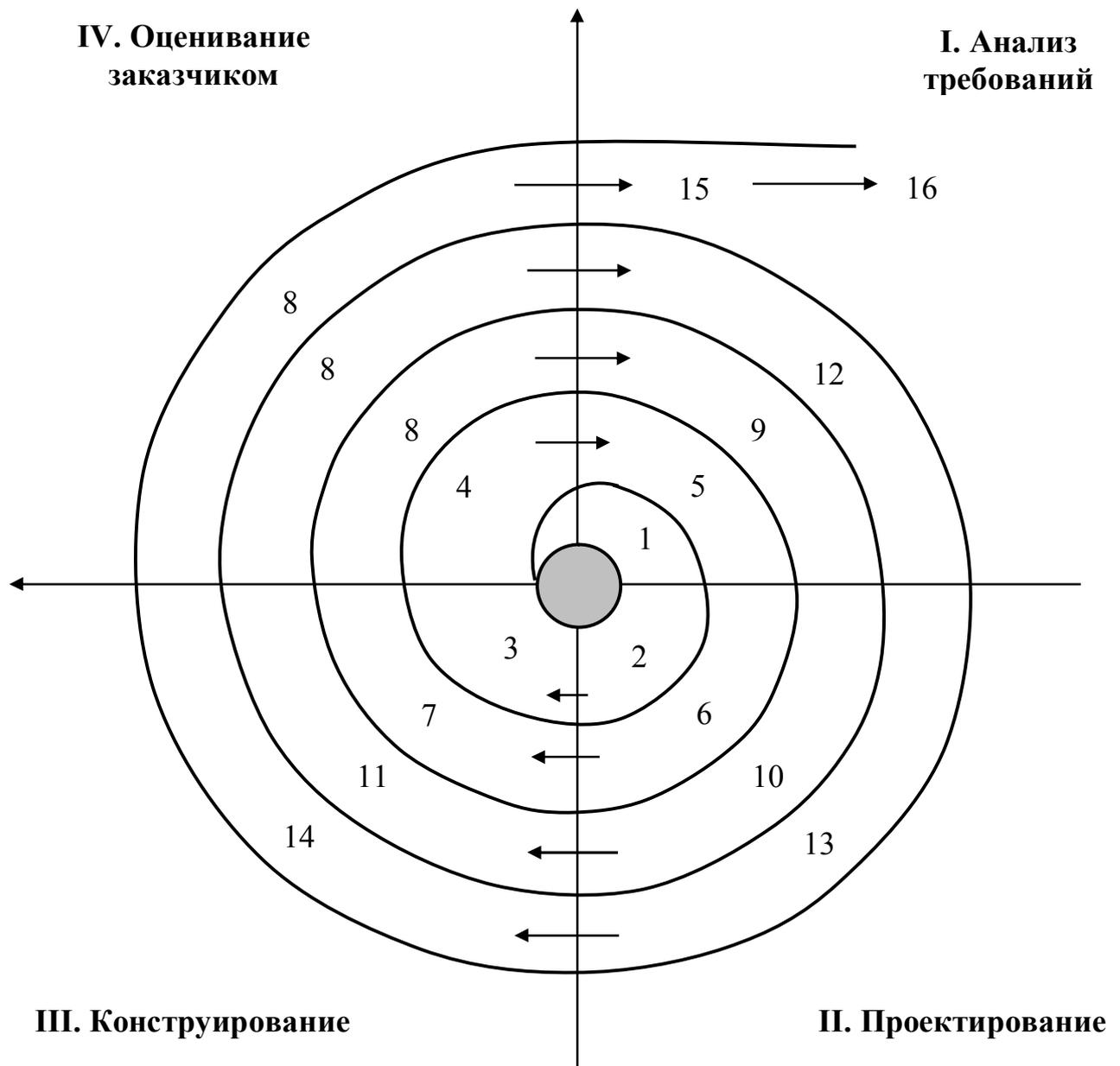
Рис. 2.20. Модель Института управления проектами PMI, адаптированная к требованиям стандарта СТБ ИСО/МЭК 12207–2003
